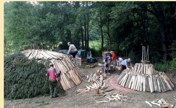
In Nohfelden-Walhausen (Saarland) werden von der AG der Walhauser Vereine alle fünf Jahre die Köhlertage veranstaltet, erneut wieder im Juli 2023. Während des Festes werden auf traditionelle Weise Holzkohlen hergestellt. Hier im Bild ist die Fichtenauflegung beim Meileraufbau zu sehen. Foto: Dietmar Böhmer
